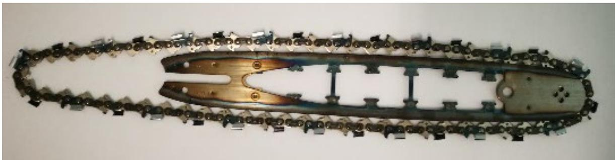
Die Kette besteht aus den Elementen Verbindungsglied, Bolzen, Treibglied und Scheidezahn.
