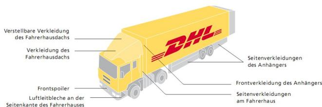
Etwa 40% des Treibstoffverbrauchs von LKW's bei Autobahngeschwindigkeit ist auf mangelnde Aerodynamik zurückzuführen. Durch einfache Veränderungen kann eine Steigerung der Kraftstoff Effizienz von ca. 10-20% erreicht werden.
